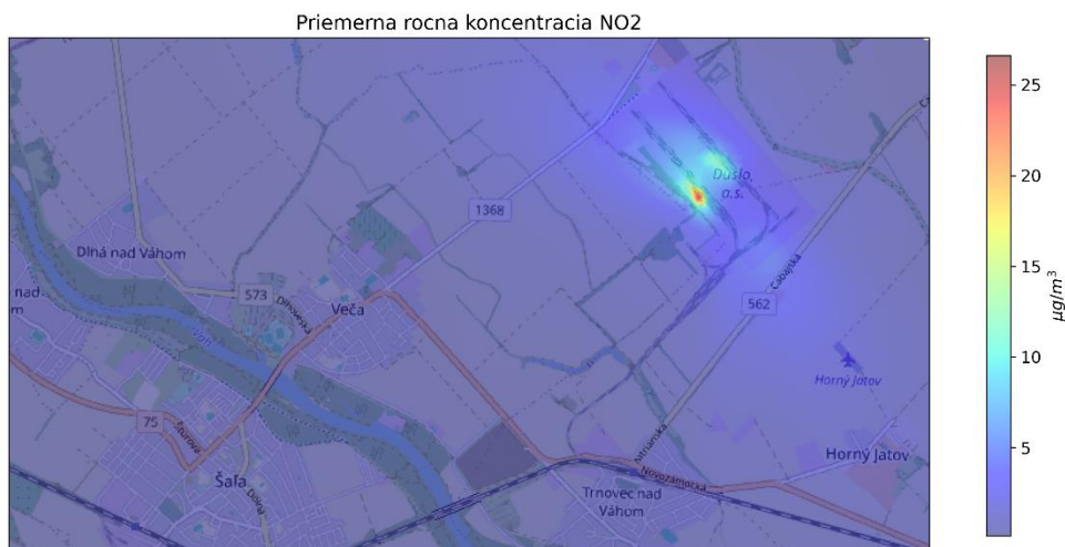
Obr. 6.1.5 Priestorové rozloženie príspevku zdrojov v areáli Duslo a. s. k priemernej ročnej koncentrácii NO 2 , modelované pomocou modelu ATMOPLAN.
